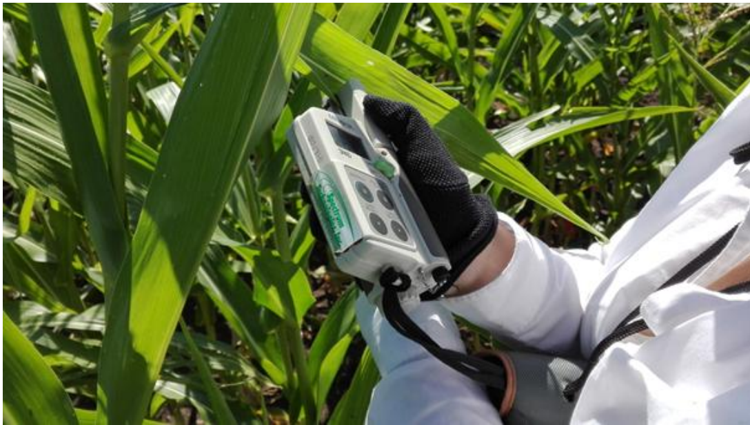
4.23. ábra. Kukorica levél klorofil-tartalmának mérése SPAD-dal
