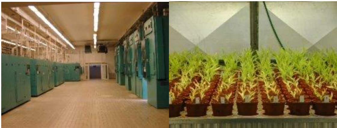
4.6. ábra. A fitotron kamrák laboratóriuma (balra), valamint a kamrák belseje (jobbra).
