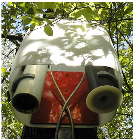
4.46. ábra. Szűrősen alapuló mintavevő PM_{2.5} méretfrakciójú aeroszol minták gyűjtésére.
