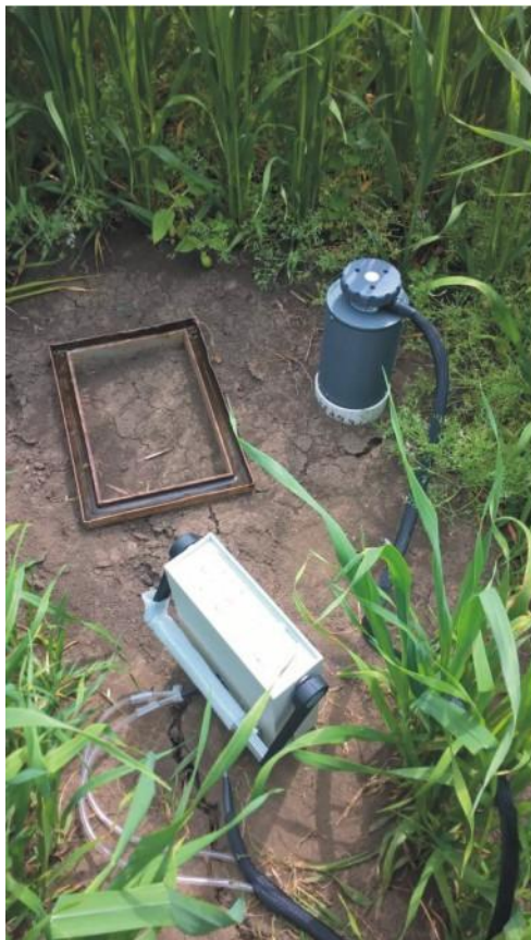
4.53. ábra. Talaj fluxus mérés EGM-4 gázanalizátor segítségével. A kép bal oldalán a statikus kamra talajba helyezett kerete látható. A jobb oldalon a két módszerrel mért fluxusok összevetése látható.
