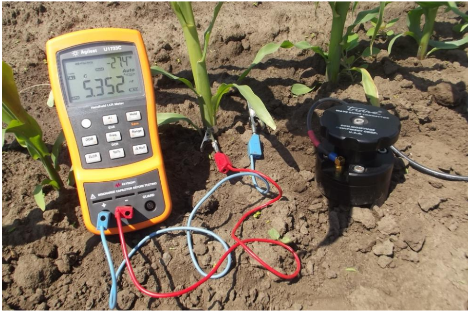
4.42. ábra. Kukorica gyökérkapacitásának mérése a talajnedvesség meghatározása mellett a martonvásári kísérleti területen.
