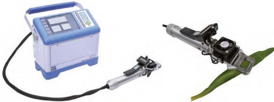
4.55. ábra. A CIRAS-3 fotoszintézis mérő, és a hozzá csatlakozható univerzális levélküvetta.
