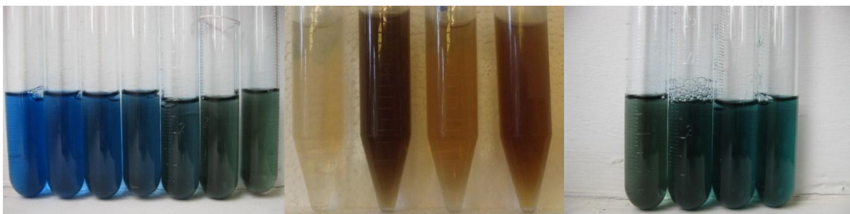
4.30. ábra. A. ábra: BSA standard sor Bradford reagenssel keverve - minél kékebb színű, annál magasabb az oldat fehérjetartalma. B. ábra: Szikes talajokból készült GRSP kivonatok - a barna szín a talaj humusz és glomalin-tartalmától is függ. C. ábra: Szikes talajokból készült GRSP kivonat Bradford reagenssel keverve. Szemmel is jól látható a különbség a fehérjetartalmakban.
