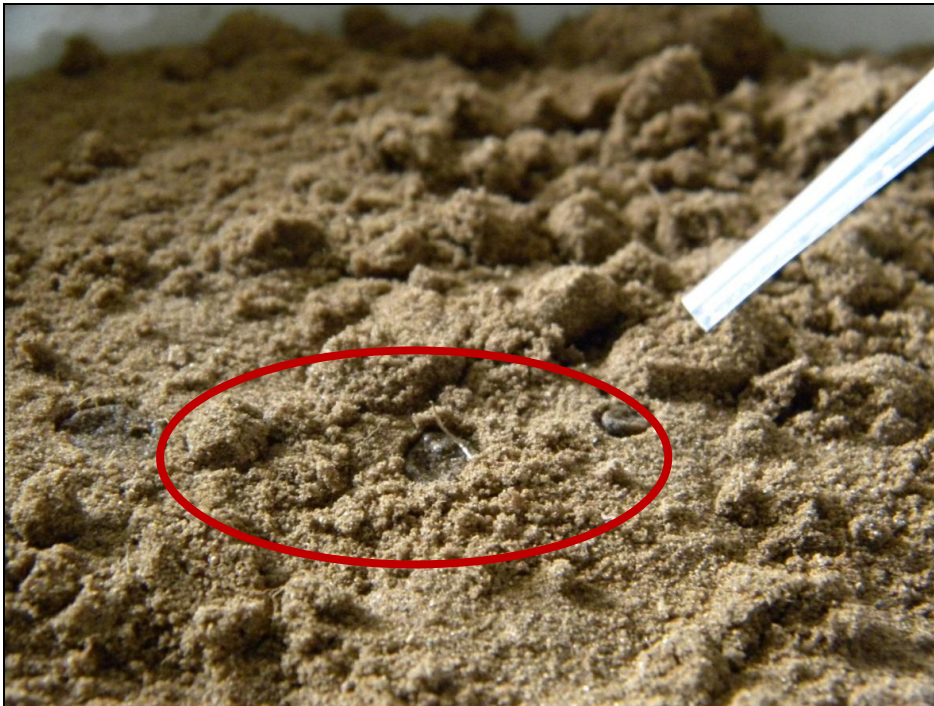
4.68. ábra. Talaj nedvesíthetőség (WDPT) teszt homoktalajon (Fotó: Sándor Renáta).
