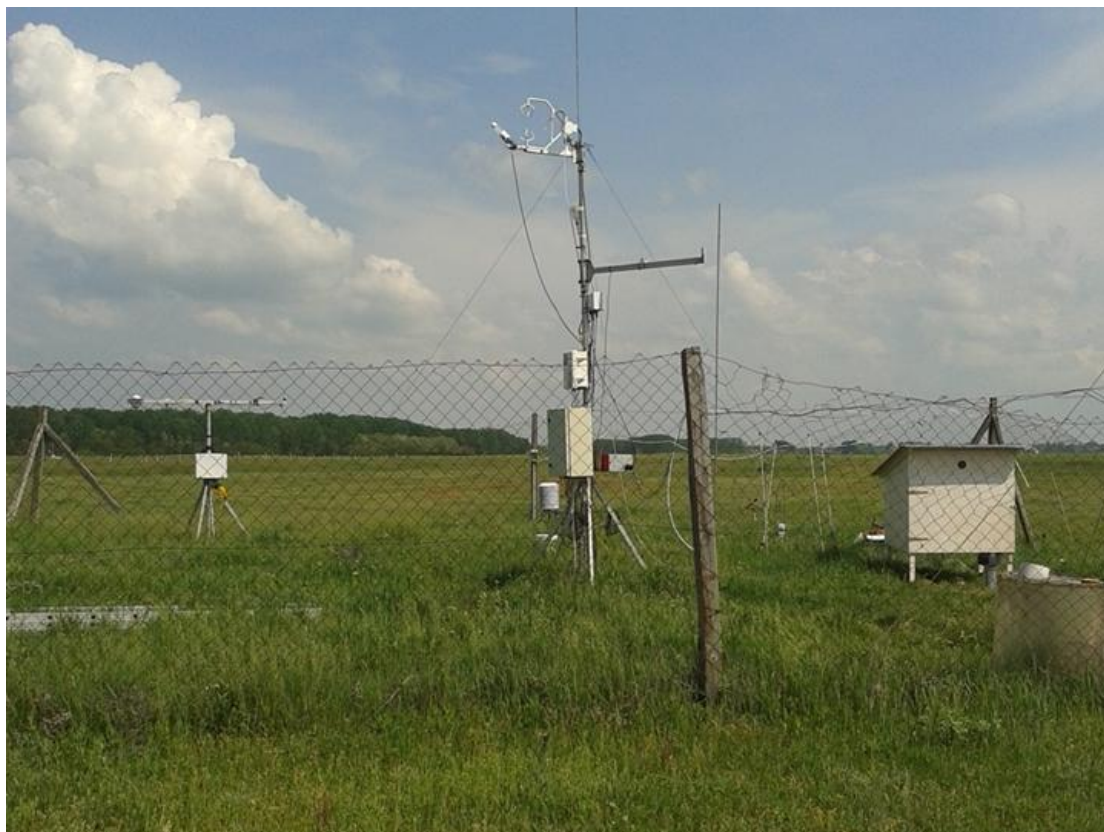
4.33. ábra. Eddy-kovariancia állomás a bugaci legeltetett területen.
